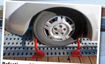
Befestigen: Alle vier Räder werden mit Krallen und Gurten gesichert.
