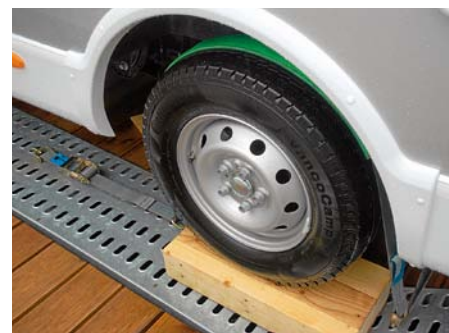
Mit Spanngurten wird das Fahrzeug gesichert. Die Details werden dabei noch optimiert.
